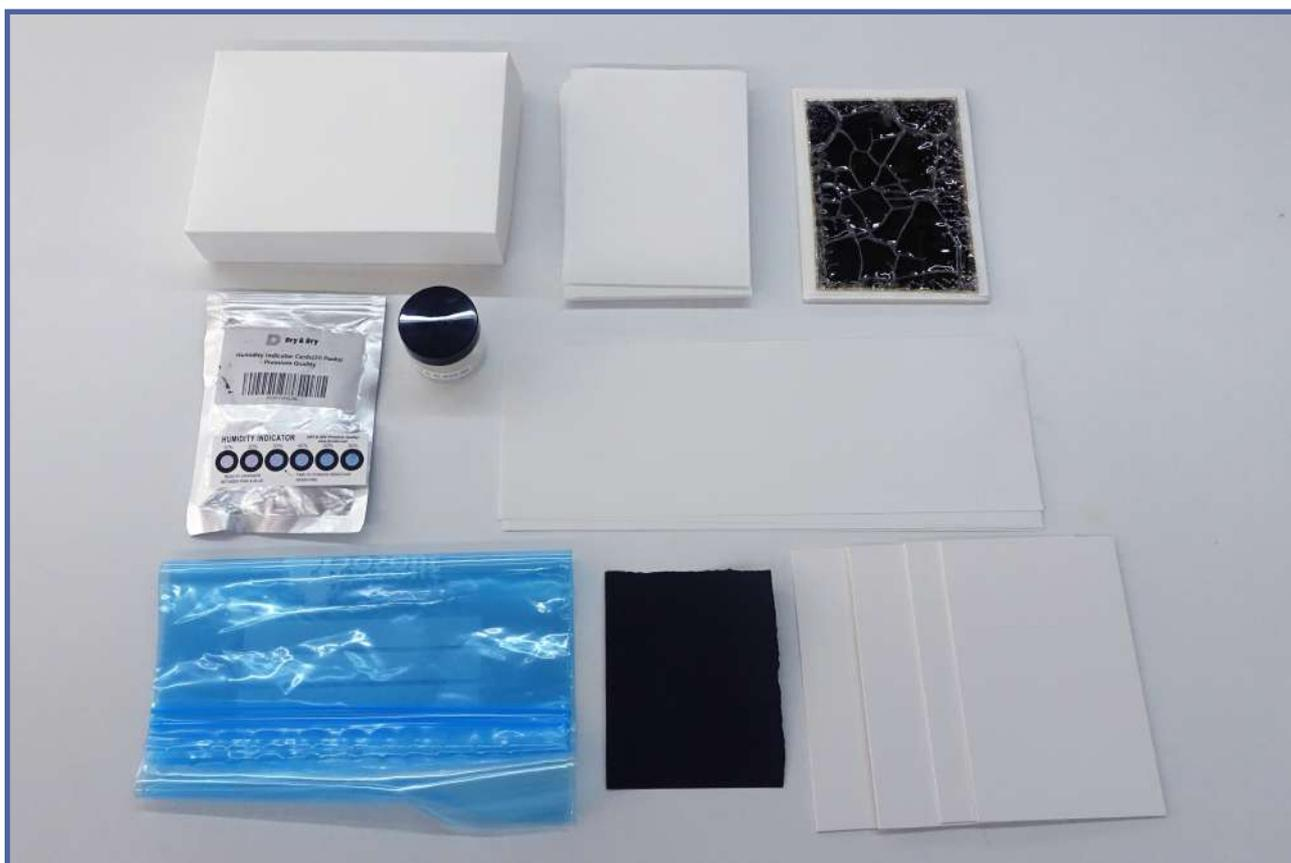
Fig. 13. Materiales. De izquierda a derecha, de arriba hacia abajo: caja de conservación a medida; sobres individuales de papel barrera; negativos en soporte de plástico; indicadores de humedad de cloruro de cobalto; gel de sílice; papel de relleno desecado; bolsas de polietileno con cierre Ziploc®; lija; cartón de enmarcar desecado.
