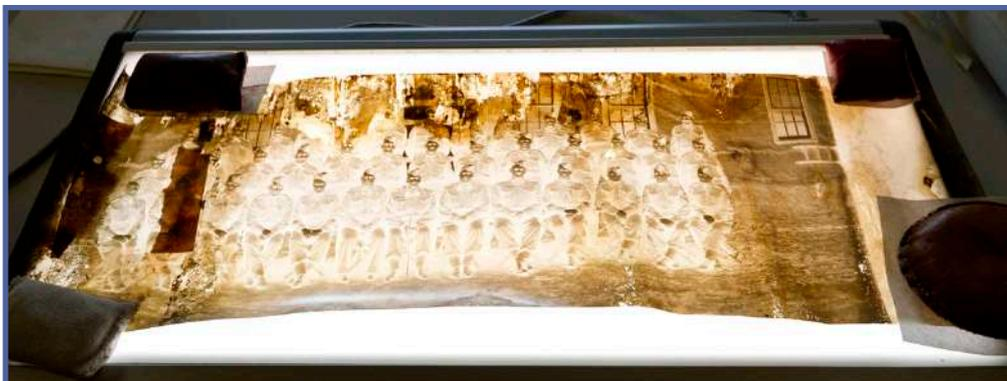
Fig. 05. Amarilleo del soporte de nitrato de celulosa.
