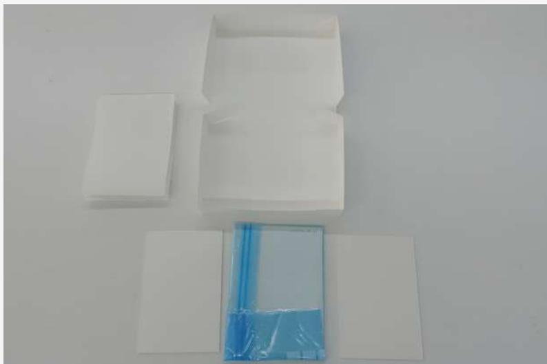
Materiales necesarios para colocar dentro de la caja de conservación: Dos cartones de enmarcar desecados. Paquete de negativos (pueden ser uno o varios, dependiendo del tamaño de la caja). Papeles de relleno.
