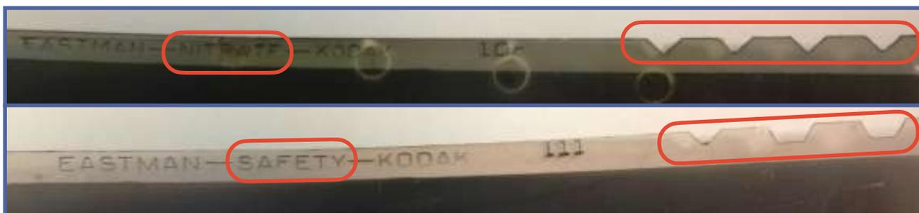
Fig. 02. Arriba: Borde superior de un negativo en placa en soporte de nitrato de celulosa, se aprecian las muescas en forma de 'V' y la palabra 'Nitrate'. Abajo: Borde superior de un negativo en placa en soporte de acetato de celulosa, se aprecian las muescas en forma de 'U' y la palabra 'Safety'.
