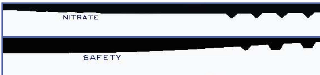
Fig. 03. Esquema para la identificación de un negativo en soporte de plástico mediante los códigos de muescas e impresión de la palabra 'Nitrate' y 'Safety'. Arriba: Nitrato de celulosa. Abajo: Acetato de celulosa.
