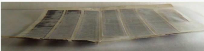
Imagen2; en la que se observan las deformaciones mecánicas y la emulsión adherida al papel glasiné.
