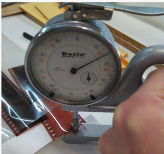
Imagen en la que se muestra cómo se procedió a medir el espesor de los negativos.
