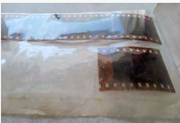
Imagen 5; detalle de los deterioros mecánicos del soporte, donde se observan ondulaciones debidas a las diferentes coeficiencias de dilatación de los materiales constitutivos de los negativos.
