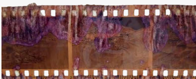
Imagen 7: en la que se observa en detalle la desnaturalización de la gelatina y cómo se ha adherido al papel. Fue realizada mediante luz transmitida.
