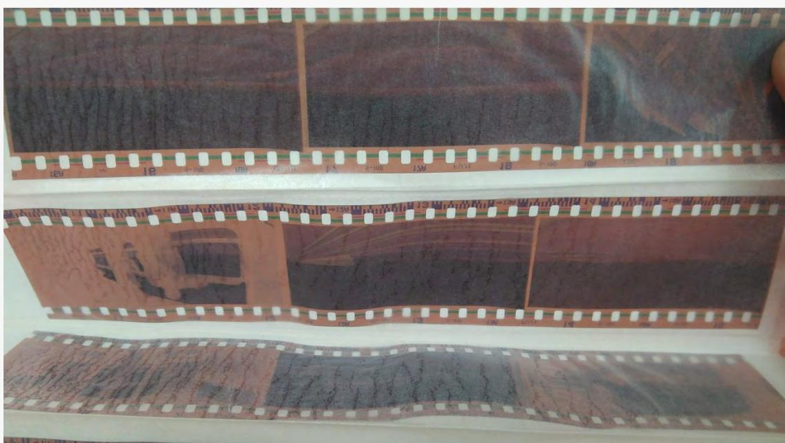
Imagen 4: en la que se observan las deformaciones mecánicas de los negativos.
