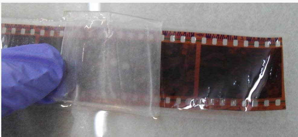
Imagen 4: una vez se encontraba totalmente desprendido, mecánicamente retirábamos el papel, de manera paralela a la fibra para no causar daños. En caso de que hubiera resistencia
